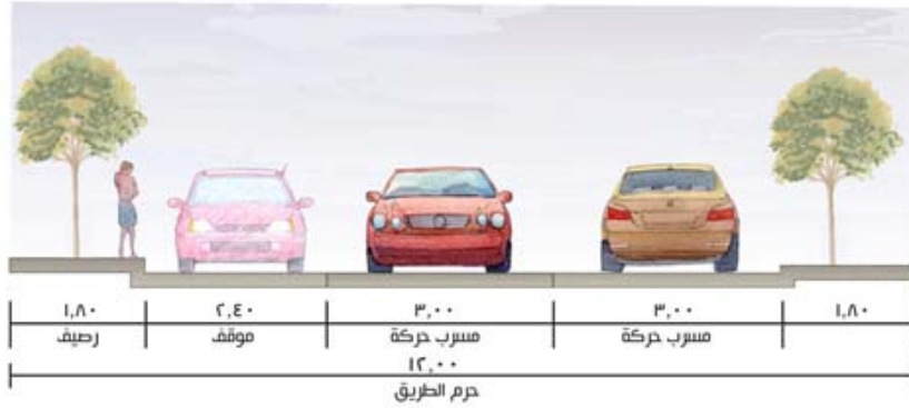
شكل (39): مثال لمقاطع عرضية نموذجية تبين الحد الأدنى لعرض طريق محلي (12 م)
